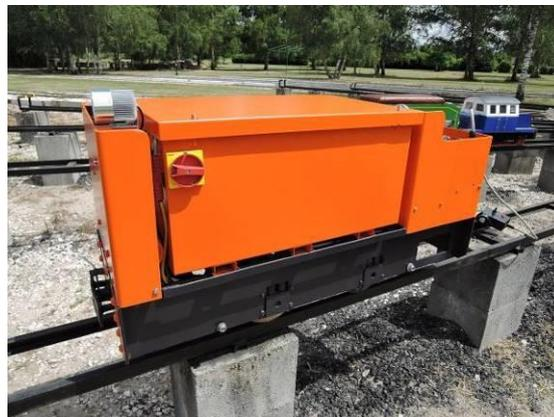
Reproduction à l'échelle 1/3 d'un locotracteur « SIG ETM50 » pour voies de 60cm, à transmission électrique par batteries. Matériel utilisé dans les mines et les travaux souterrains.
