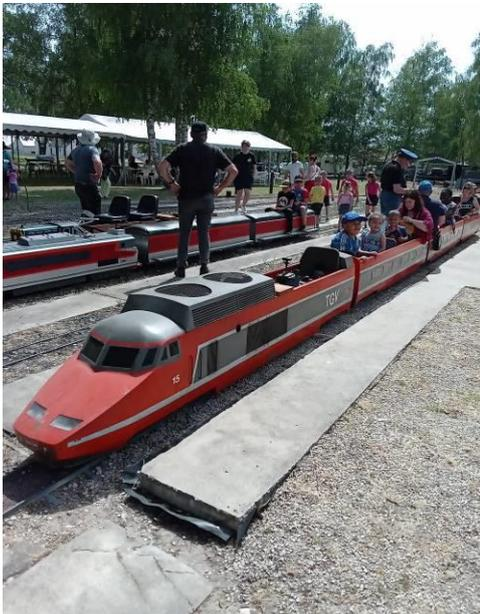
Le TGV ayant eu encore des faiblesses lors de nos journées d'août, et provoqué un déraillement suite à une rupture sur le bogie arrière de la motrice. Ce bogie a été réparé, et l'attelage aux voitures suivantes a été modifié.
